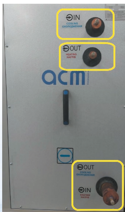
Мал. 26. Реверсивний фреоновий теплообмінник.
