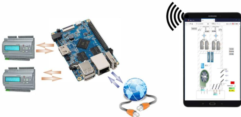
За допомогою спеціального апаратно-програмного забезпечення можливий віддалений контроль, управління, моніторинг параметрів установки за допомогою браузера комп’ютера або мобільних пристроїв (телефон, планшет). Також, можна організувати повноцінне місце оператора с встановленим спеціалізованим ПЗ.
